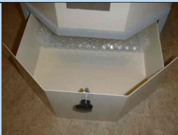
本体下部の引き出し部分 ここに大きな石膏くずが溜まります
